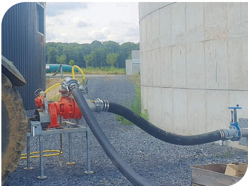
Pompe HD Doda derrière prise de force tracteur - Transfert de digestat
