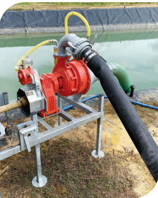
Pompe HD Doda derrière prise de force tracteur - Transfert de digestat
