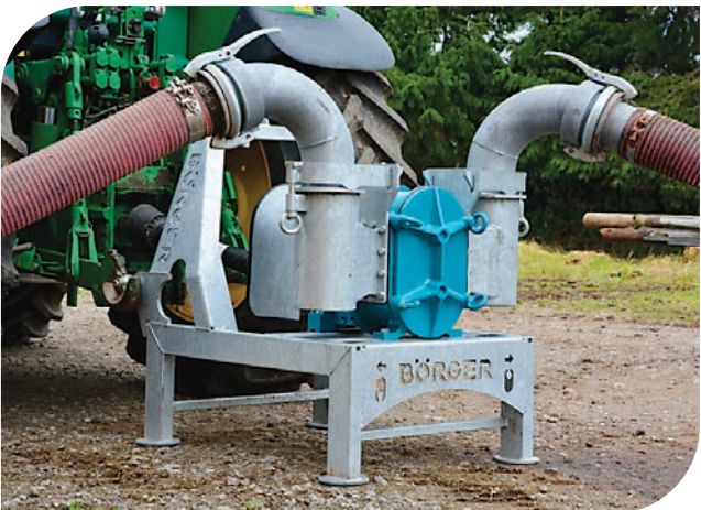
Pompe Börger PL200 derrière prise de force tracteur Pompage et refoulement de digestat
